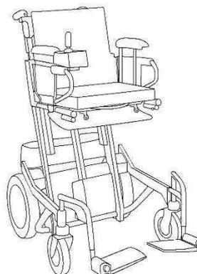
※座面の高さが電動で上下します。
